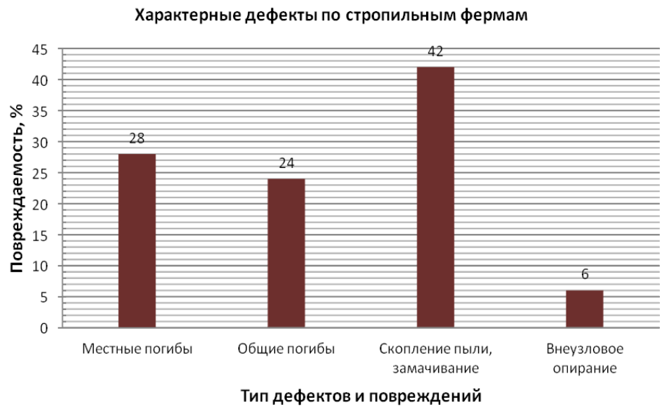
Рис. 3. Характерные дефекты по стропильным фермам предприятий энергетики
