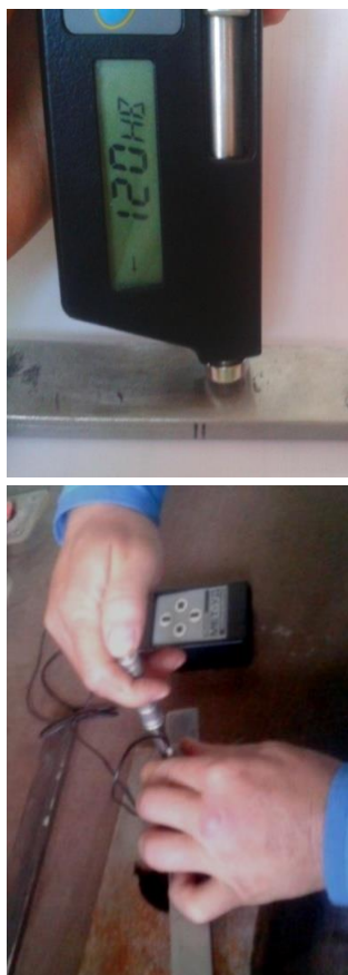
Рис. 5. Портативные твердомеры ТЭМП-4 и МЕТ-УД
