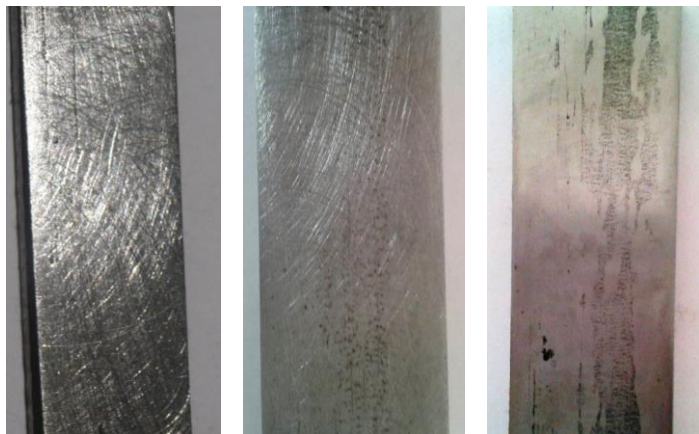
I – грубый шлиф II – средний шлиф III – гладкий шлиф
