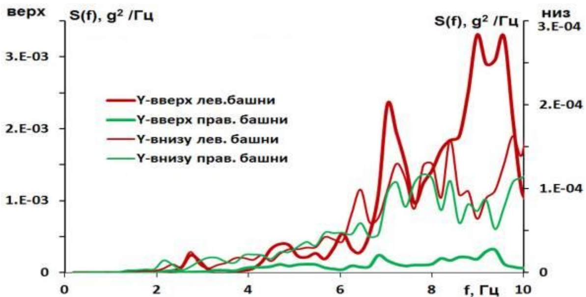
Рисунок 9 – Спектры мощности колебаний стены при прохождении поезда, регистрация одновременно в верхней (толстая линия) и в нижней частях башни, акселерометры, компонента поперек стены
