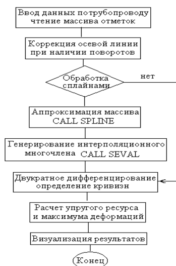
Рис. 5. Блок-схема программы STAIRS обработки рядов планово-высотных отметок сглаживанием кубическими сплайнами
