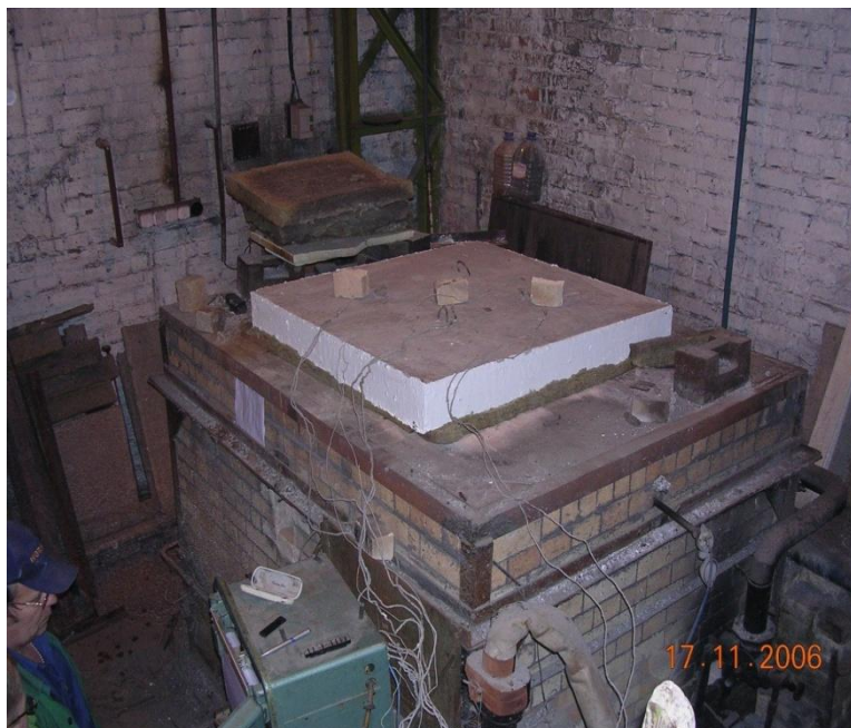
Рис.2. Общий вид огневой установки и испытуемого образца железобетонной плиты
