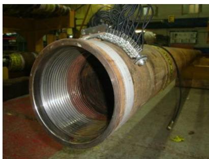
Рис.1 Участок бурового ствола (статор насоса), вид с торца с внутренней резьбой. СУ – сканирующее устройство, подключенное к прибору типа ИКН.
