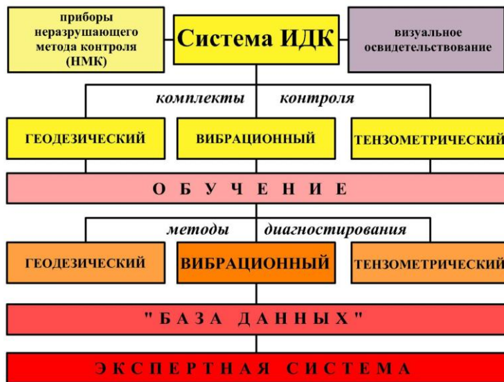
Рис. 7. Структурная блок-схема системы ИДК на СС.
