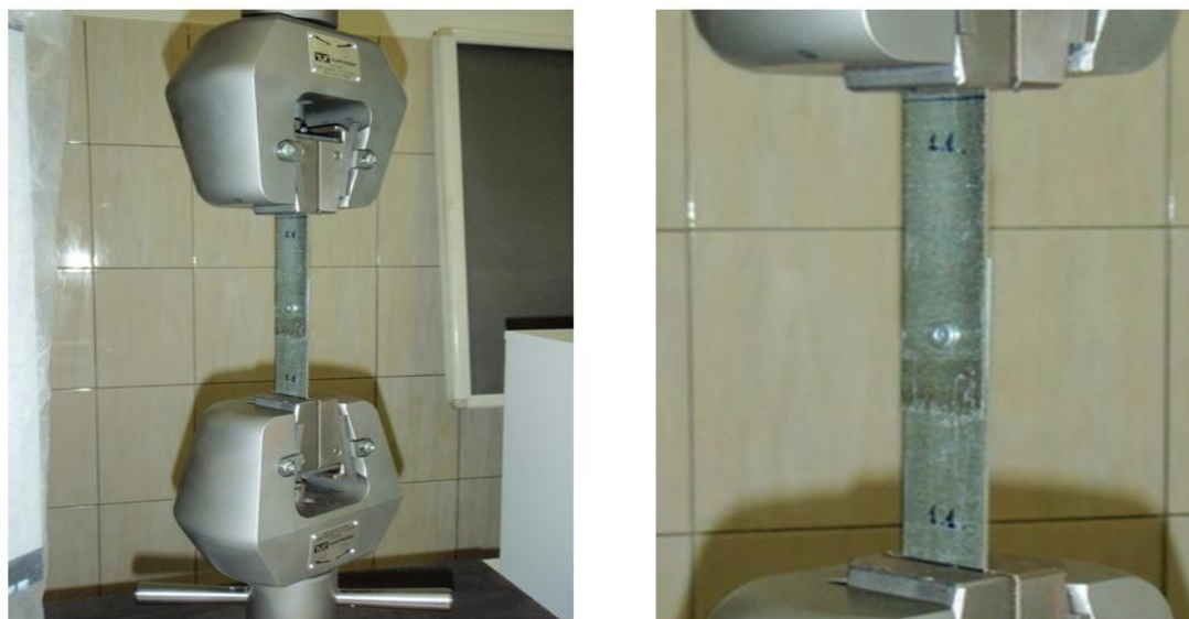
Рисунок 6. Образец для испытания соединений на срез.
