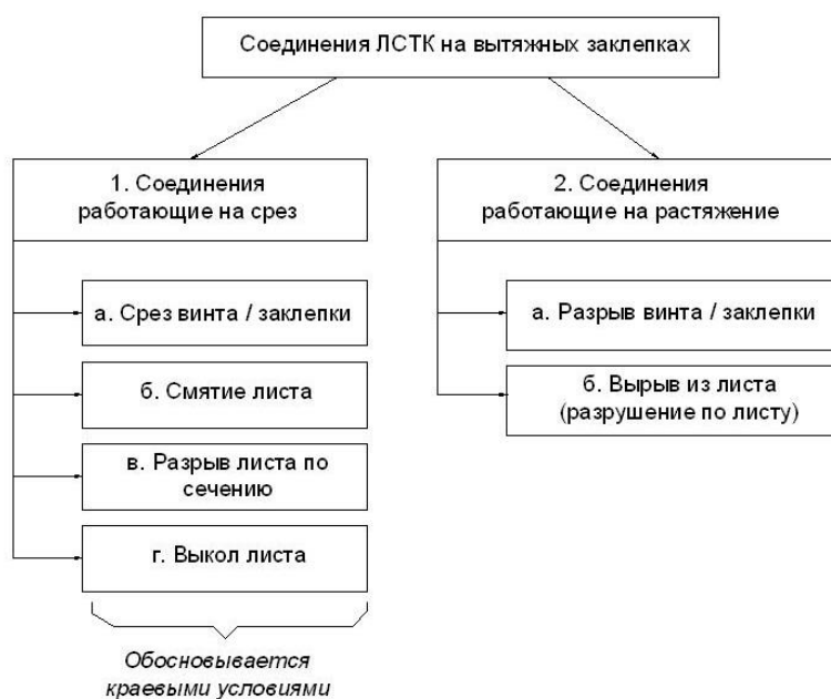
Схема 1. Типы отказов соединений ЛСТК на вытяжных заклепках и винтах.
